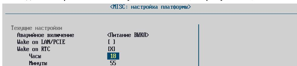
Рисунок 38 – Параметр «Wake on RTC»
